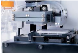
1536孔板清洗采用2个32道分液头和1个128道抽吸头以提高洗板速度
