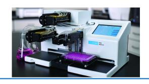
MultiFlo™ FX是一款模块化与自动化的多功能分液系统, 兼容6-1536孔板,一次操作最多可独立支持4种试剂进行 平行分液。由于采用BioTek公司专利的平行分液技术, 能够同时满足用户对蠕动泵或注射器泵不同分液技术的 需求。整体操作全自动化,最低分液量可达500nL,不但 节省了宝贵的试剂,同时降低了维护和耗材成本。在传 统的液体分装功能之外,MultiFlo Fx还具有其他更为灵活 的功能模块,如选择专利技术的RAD™模块,可以实现对 任意孔进行任意体积的灵活加样,以及对大孔径微孔板 进行快速高通量的分装操作。此外还可以选择一个6-384 孔板的洗板模块,以满足多任务、多功能操作的需求。 其全部功能配置多达5种液体处理模块,大大节省了实验 空间、操作时间和购置预算。
